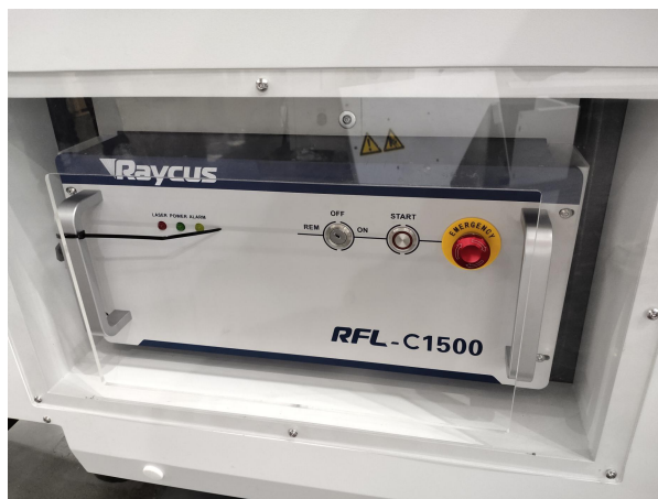
Кнопка аварийной остановки на источнике лазерного излучения (Внимание! Марка и модель излучателя могут отличаться от представленных на фото)
