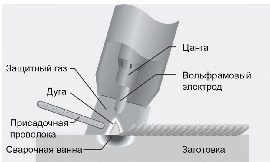
Для подачи сварочного тока обычно используются источники постоянного или переменного тока с постоянными выходными характеристиками. Для работы на постоянном токе силовой разъем сварочной горелки с вольфрамовым электродом можно подключить к любой выходной клемме, но чаще всего он подключается к отрицательной клемме.
